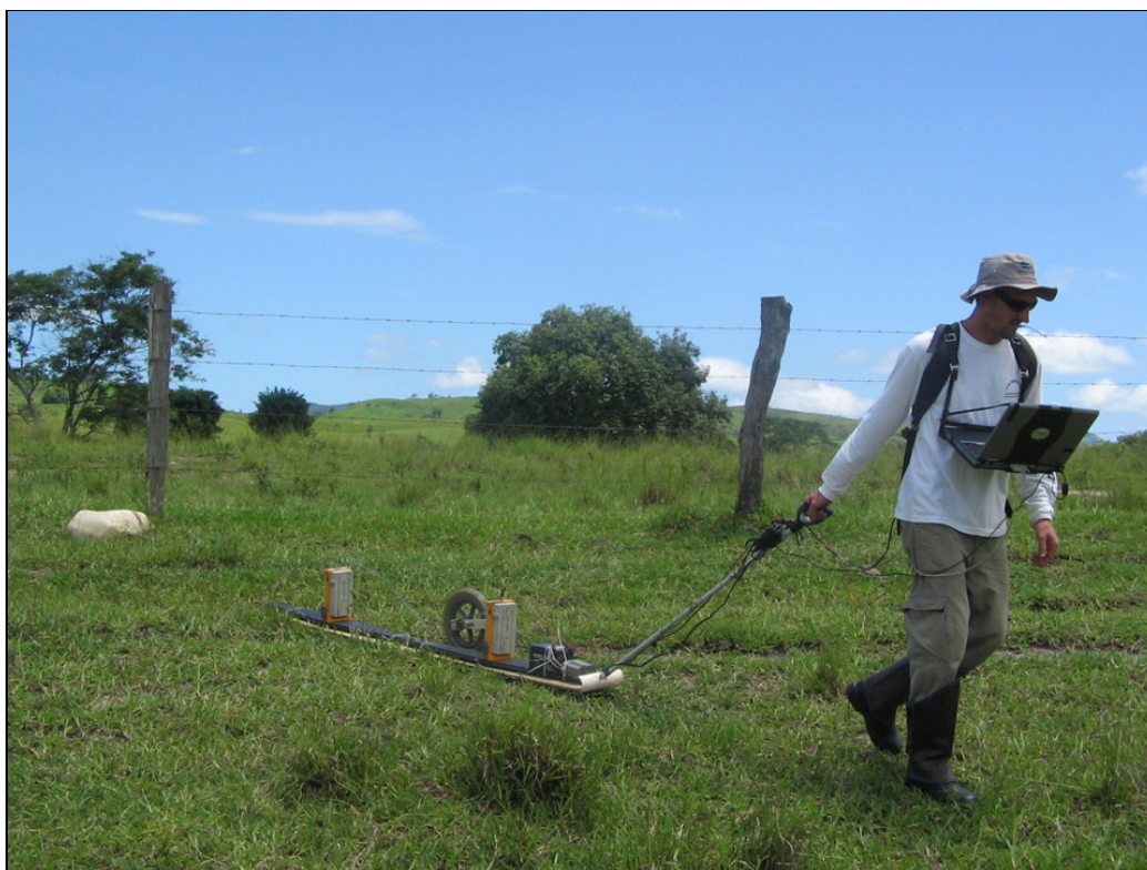
Figura 5. Equipamento utilizado na área com antena de 100MHz.
