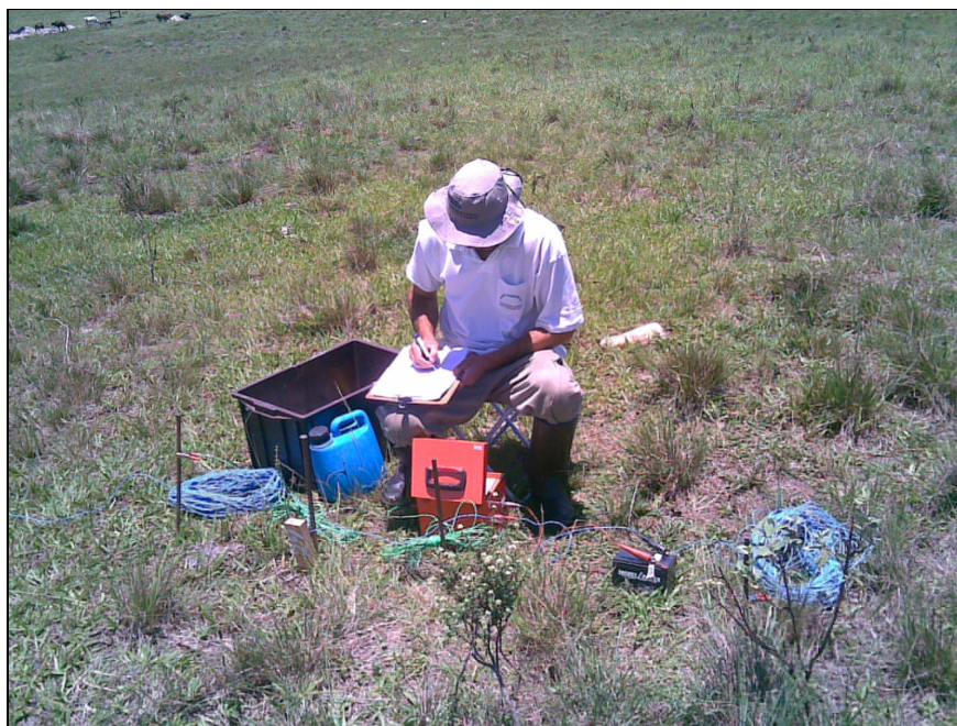
Figura 9. Resistivímetro utilizado durante o levantamento de dados.
